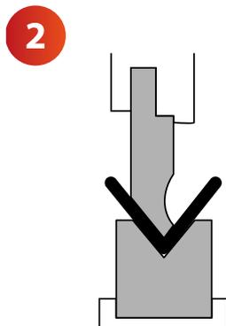
**2. Pliage à fond:** c'est celui qui est réalisé sur la matrice en pressant la tôle avec le poinçon jusqu'à atteindre la partie inférieure de la matrice. L'angle de pliage qui en résulte dépend des outils utilisés.
