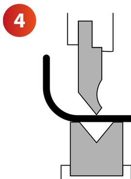
**4. Calandrage:** il permet d'obtenir différents rayons de courbure d'une tôle à partir de multiples pliages réalisés en séquences sur la même tôle.
