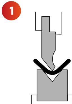
**1. Pliage en l'air:** c'est celui qui est réalisé sur la matrice sans que la tôle pliée par le poinçon arrive à toucher la matrice. Ceci permet d'obtenir différents angles de pliage en utilisant les mêmes outils et demande une grande précision pour garantir un parfait résultat.
