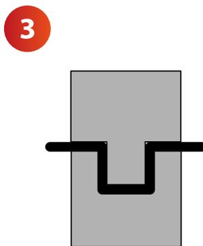
**3. Impression:** elle permet de réaliser un pliage de la tôle sur elle-même pour lui donner plus de résistance sur des zones déterminées.
