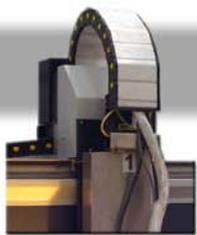
Ce modèle utilise deux **poutres indépendantes** afin d'isoler la grille de coupe des axes de mouvement de la machine, évitant ainsi la transmission d'à-coups et les vibrations.
