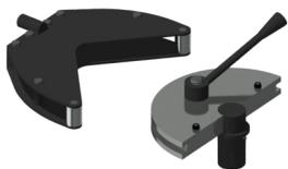
Matrice pour plier un tube carré, creu ou plein, avec un rayon déterminé et des degrés concrets. Pour sa fabrication, il faut des plans ou une pièce en modèle.
