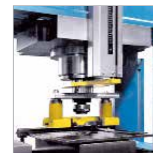
Équipement de poinçonnage pour diamètres de 6 mm à 40 mm.
