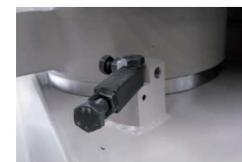
Buttute meccaniche per la rotazione rapida dell'arco ai gradi 0°, 45° e 60°.
