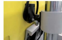
Dispositivo con snodo sferico per consentire l'assorbimento di tensione della struttura dell'arco ed avere una regolare linearità della discesa di taglio.
