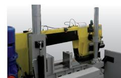
Discesa arco su due colonne cromate con lubrificazione centralizzata manuale.
