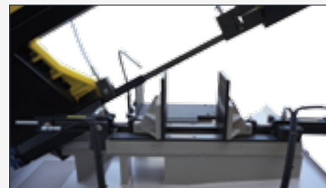
Morsa autocentrante. Self-centring vice.
