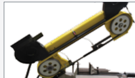
Carter arco incernierato. Hinged head guard.
