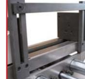
Il telaio di contenimento è indicato nei tagli "a fascio" perché mantiene allineate le barre, previene spostamenti accidentali del materiale e ne evita il sollevamento durante la movimentazione della morsa carro.
