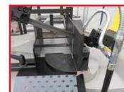
Piani della morsa taglio e carro dotati di spine temperate sostituibili in caso di usura. Avvicinamento della ganascia mobile tramite una vite trapezoidale che garantisce un sistema di manovra scorrevole ed efficiente anche ad elevati carichi. Accoppiamento slitta morsa prismatico per una maggior precisione. Ganasse sostituibili in caso di usura. Ganasse d'appoggio per il sostegno del materiale in uscita.
