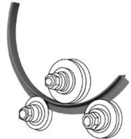
Galets ajustables par des rondelles à la mesure du tube ou profilé, ce qui nous permet de réaliser des courbes de différentes dimensions de tube ou de profilé.
