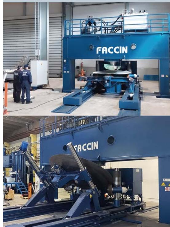
PPM est la série de presses hydrauliques Faccin robustes, fiables et efficaces. Conçues et construites par Faccin, ce sont des presses adaptées au couronnement de fonds bombés, comportant un design exclusif avec des tirants et disponibles dans diverses tailles. Pour choisir la taille exacte, il est nécessaire de calculer le développement du plus grand fond bombé à être produit qui indique la distance entre les montants. L'épaisseur maximale guidera le choix de la force de la machine.
